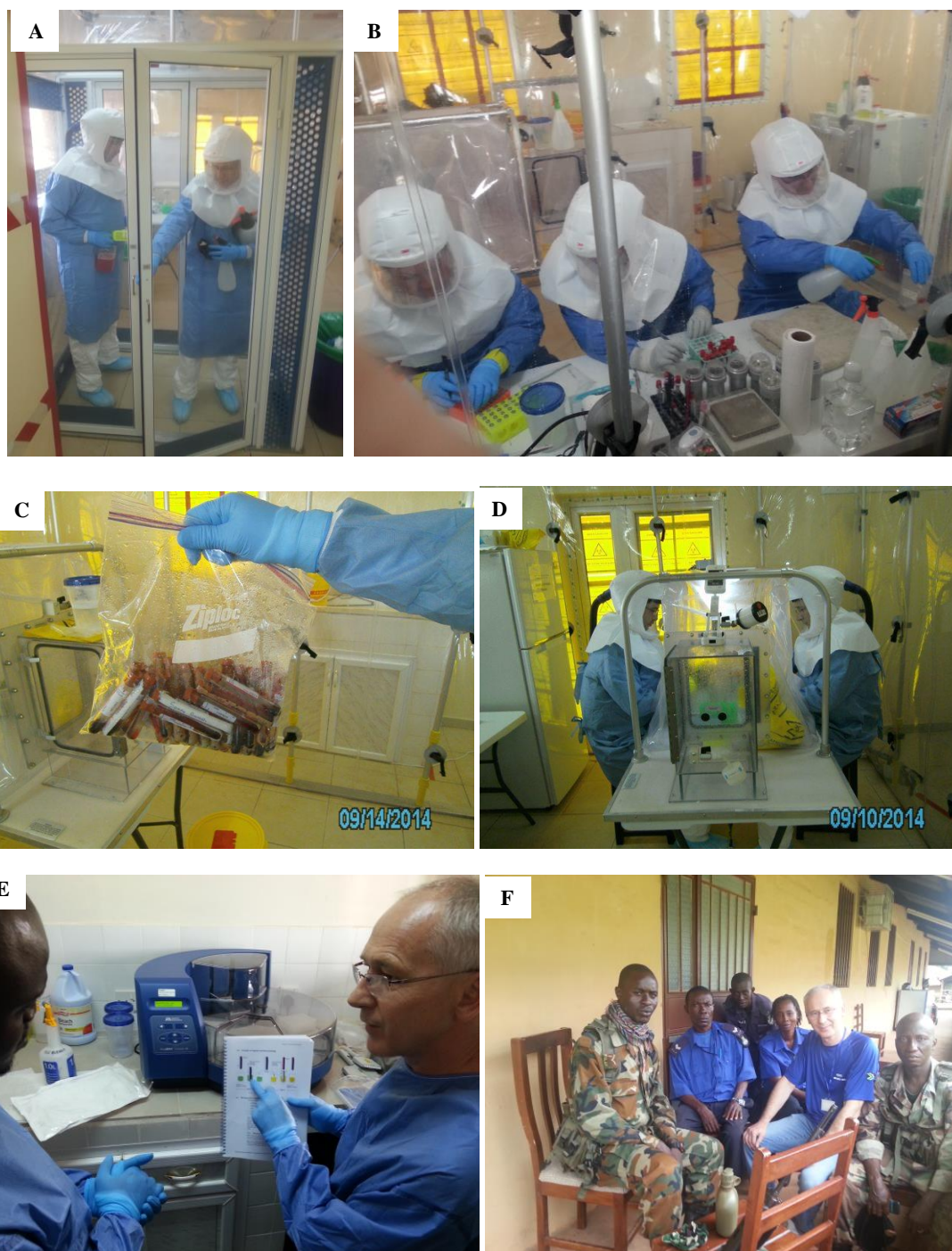
Ryc. 2. NICD/NHLS polowe laboratorium BSL3 do molekularnej diagnostyki zakażeń wirusem Ebola, Freetown, Sierra Leone, Zachodnia Afryka. A - wejście operatorów w ubiorach ochronnych z urządzeniem do filtracji powietrza przez służę do komory z podciśnieniem zapewniającym trzecią klasę bezpieczeństwa biologicznego; B - identyfikacja i przygotowanie prób klinicznych do ekstrakcji wirusowego RNA; C - próbki krwi pobrane od pacjentów podejrzanych o zakażenie wirusem Ebola; D - "gorąca" ekstrakcja RNA z prób krwi w komorze izolacyjnej pod negatywnym ciśnieniem; E - szkolenie lokalnego personelu medycznego w molekularnych technikach diagnostycznych EVD; F – Prof. J. Pawęska z grupą żołnierzy i służb ochrony odpowiedzialnych za ochronę laboratorium.
