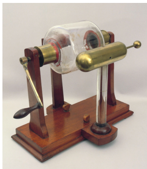
Ryc. 6. Maszyna elektrostatyczna bębnowa typu Nairne'a, Anglia, koniec XVIII w. (Własność Muzeum Uniwersytetu Jagiellońskiego)
