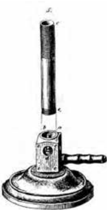
Ryc. 2. Palnik Bunsena (Bunsen, Roscoe 1859, pl. 1, ryc. 5)
