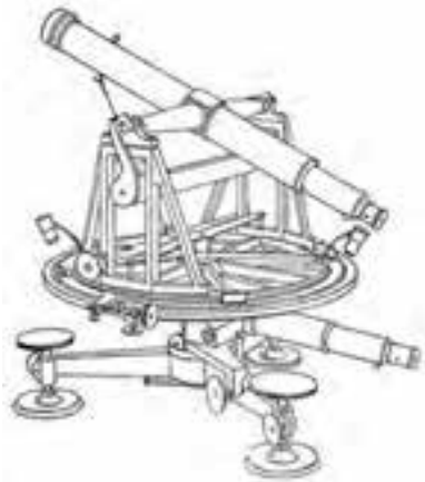
Ryc. 3. Teodolit von Reichenbacha (Dyck 1912, s. 25, ryc. 8)
